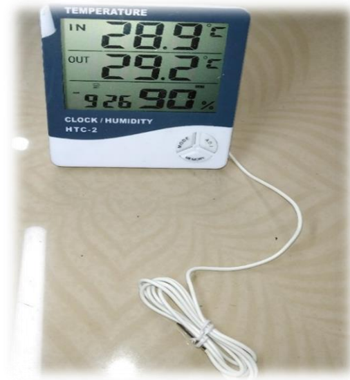
Fig.4.4: Temp. + Humidity meter
