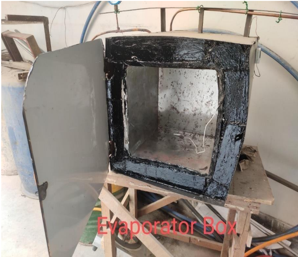
Fig- 2.2.10 : Evaporator box
